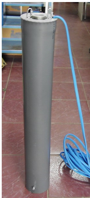
КОЖУХ ЗА ОХЛАЖДАНЕ НА ДВИГАТЕЛ ПОТОПЯЕМА СОНДАЖНА ПОМПА ПРИ ДИАМЕТЪР НА ВОДОИЗТОЧНИКА > ф 250 мм
